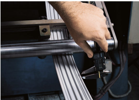
Qualitätskontrolle während der Extrusion der Wickelrohrprofile
